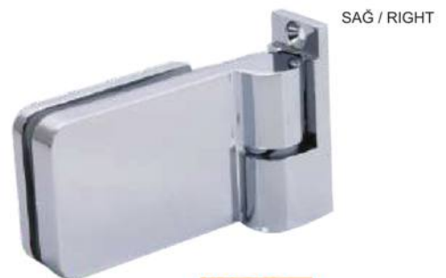
DUVARDAN CAMA SAĞ, 90° dışa açılır Asansörlü 6-8 mm cam (Zamak)
